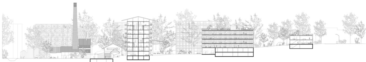
Abb. Nord-Süd-Schnitt durch das Areal - ganz rechts das um 1 Geschoss reduzierte Gebäude B an der Tumigerstrasse
